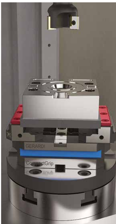
Tramite l'inserto Grip si esegue la sgrossatura e la finitura del pezzo sui cinque lati. Through the Grip insert you can rough mill and finish the workpiece on five sides.
